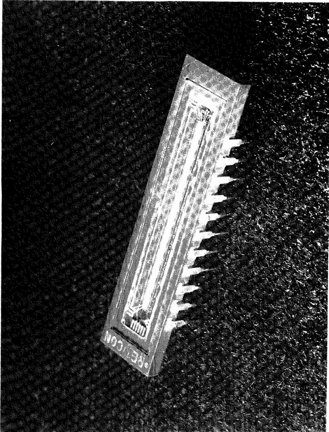
FIG 2 PHOTODIODE ARRAY DETECTOR
