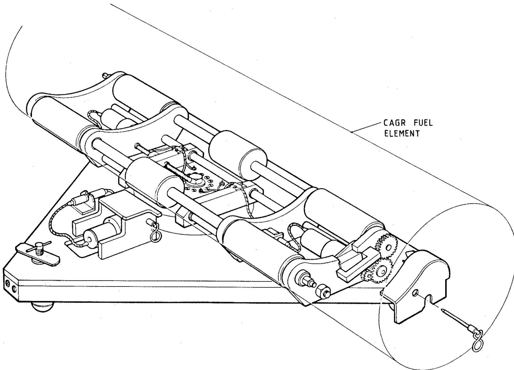
FIG 6 FUEL ELEMENT INSPECTION TURNTABLE
