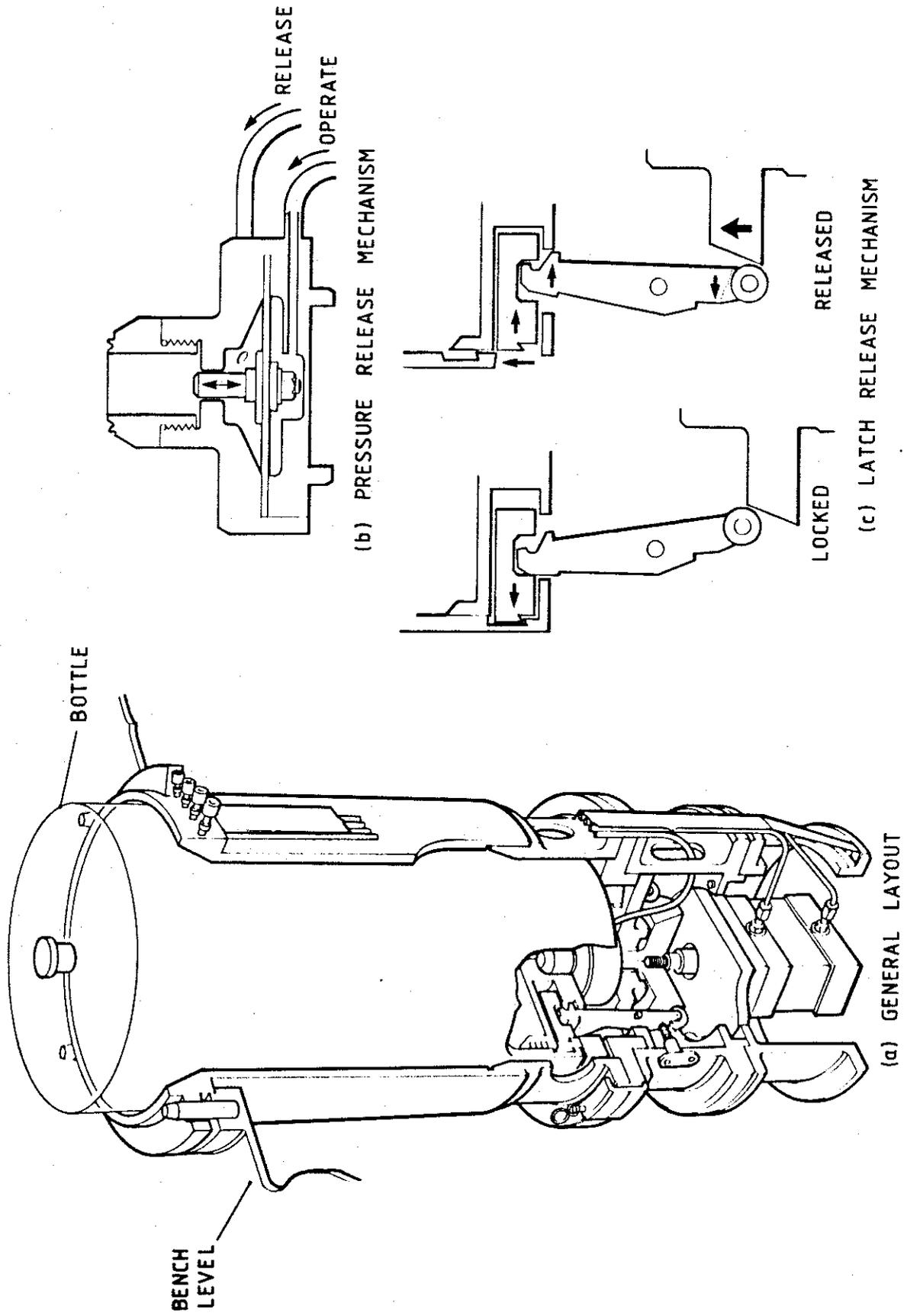
FIG.3 CAP REMOVAL MACHINE FOR HINKLEY TYPE BOTTLES
