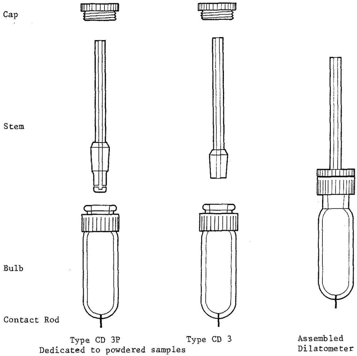
Fig. 1 : Dilatometer
