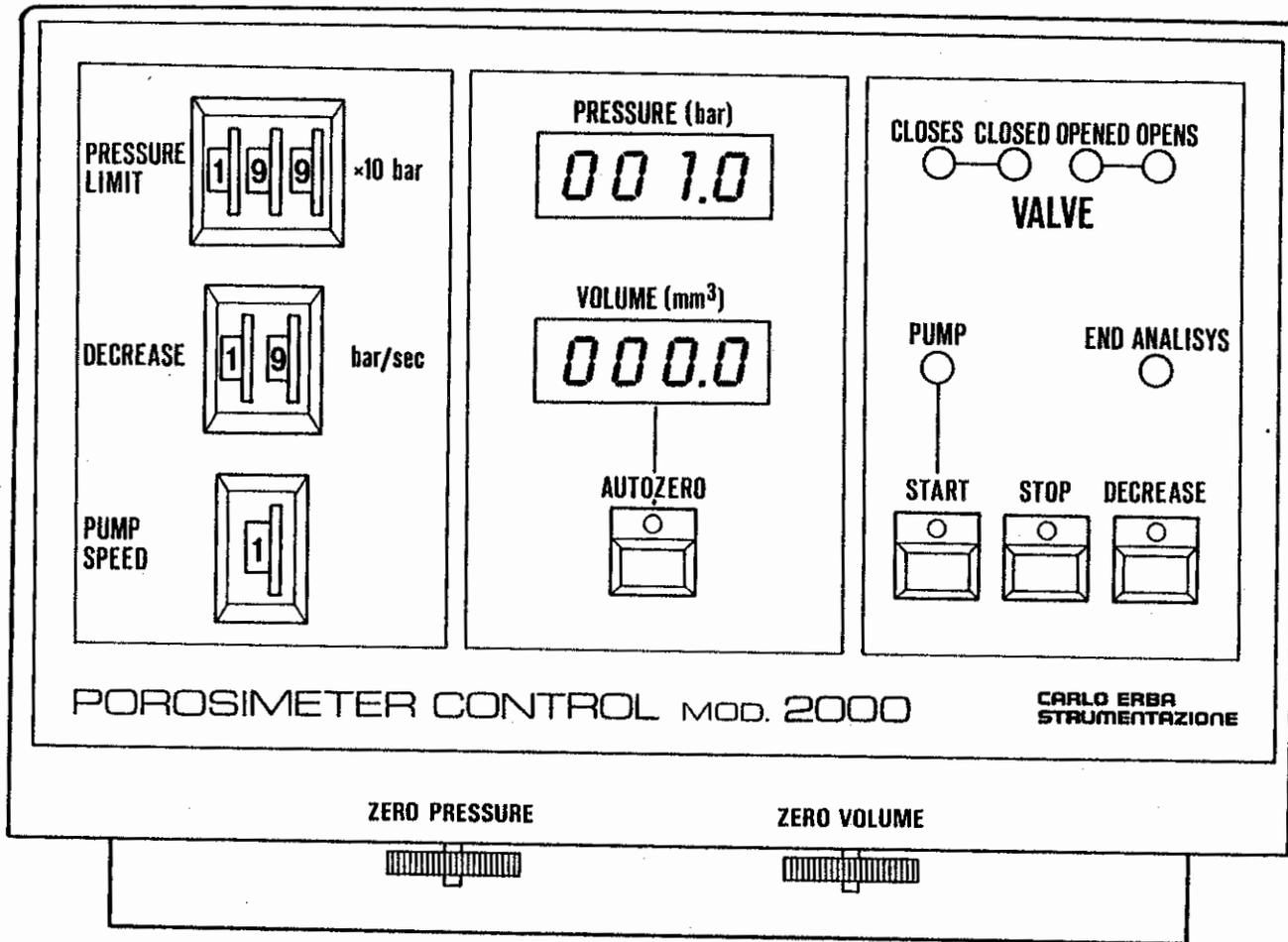
Fig. 5 : Porosimeter Control Unit
