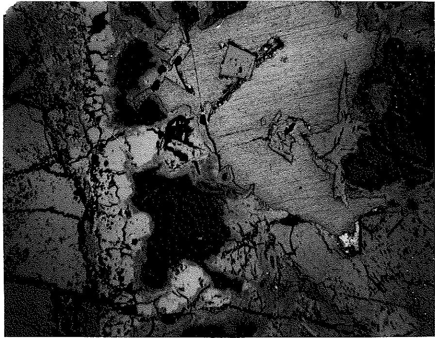
Abb.3: Lichtmikroskopisches Bild - (reaktives Besputtern); Interferenzfarben; Farbpolaroid; Vergr: 160fach Probe - TMI 2 - Kernschmelze
