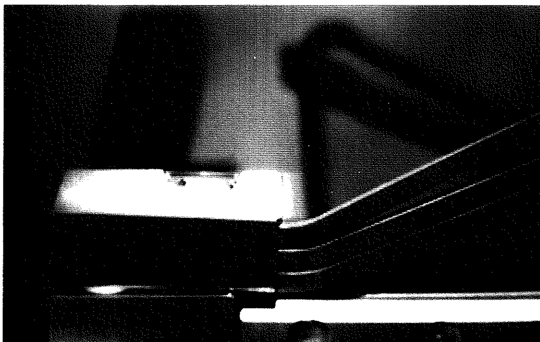
Décollement du talon de matière d'un ressort de tube d'assemblage
