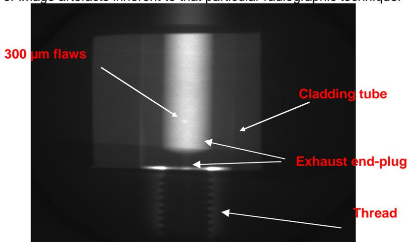
**Fig. 14** : Weld radioscopy
