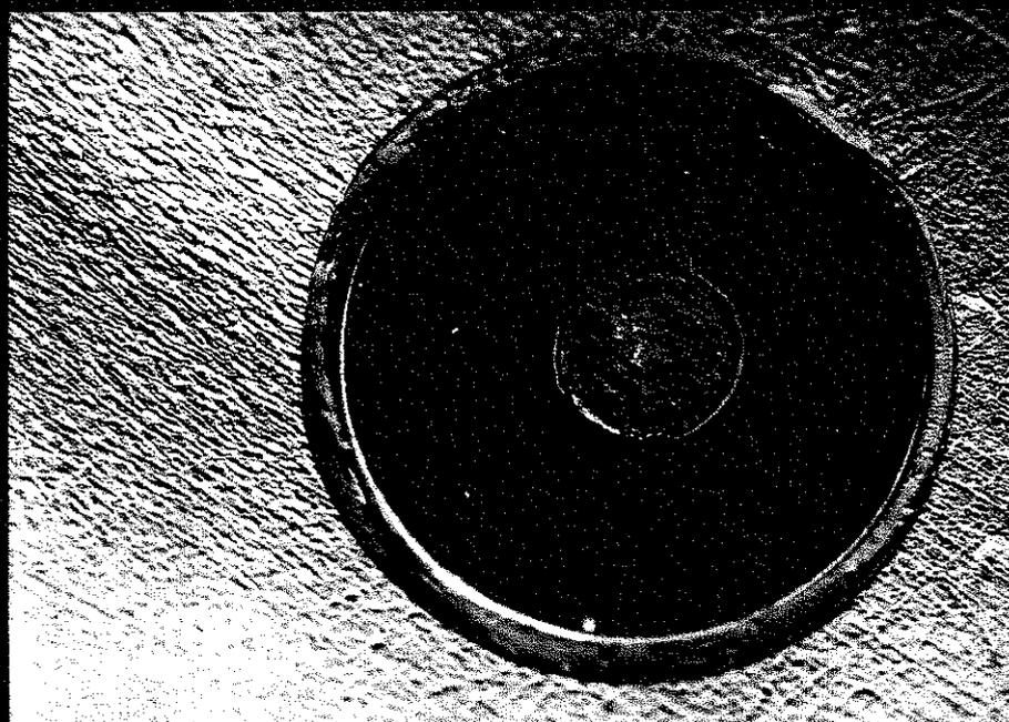
Lame mince d' $\text{UO}_2$  .Epaisseur  $\approx 80\mu\text{m}$
